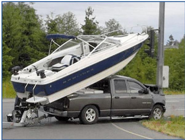
Die Sicherungskräfte für Ladegüter sind in Richtlinien festgelegt (siehe VDI 2700 ff.). Danach muss die Ladung in Fahrtrichtung, zur Seite und nach hinten bestimmten Massenkräften standhalten. **Auch Boote müssen während des Transportes auf dem Bootsanhänger/Trailer ausreichend gesichert sein.**
