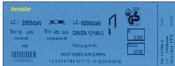
Hanf- oder Textelseile sowie Leinen sind für Sicherungsmaßnahmen nicht zulässig! Beschädigte/verschlissene (ablegereife) oder geknotete Zurrmittel dürfen nicht verwendet werden. Ihre Zurrkraft ist nicht berechenbar; sie zählen bei einer Kontrolle deshalb als „nicht vorhanden“.
